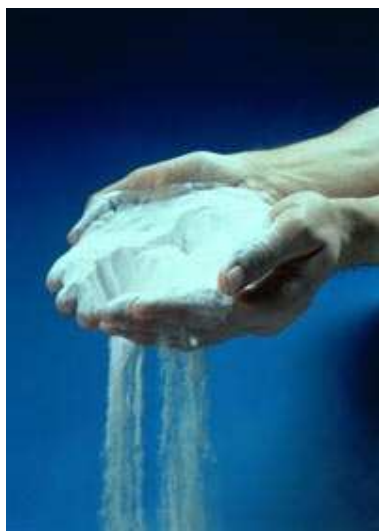
Figuur S.3 — Alumina (amorf \text{Al}_2\text{O}_3 ) is de ruwe vorm waarin aluminium hier op aarde voorkomt. Splitsing in aluminium en koolstofdioxide gebeurt door elektrolyse en toevoeging van koolstof.
